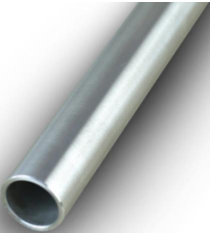
镀锌钢管，它有着耐腐蚀性能和使用寿命长的双重优点，并且价格相应比较低廉，所以现在它的使用率也是越来越高了，但是有的使用者在焊接镀锌管时不注意，导致了一些不必要的麻烦，那么镀锌管在焊接时都应该注意哪些问题呢？必须把焊接处的镀锌层打磨掉，否则会产生气泡、沙眼、假焊等。还会使焊缝变脆，刚性下降。镀锌钢一般是在低碳钢外镀一层锌，镀锌层一般在20um厚。锌的熔点在419°C，沸点908°C左右。在焊接中，锌熔化成液体浮在熔池表面或在焊缝根部位置。锌在铁中具有较大固溶度，锌液体会沿晶界深入浸蚀焊缝金属，低熔点锌形成“液体金属脆化”。上海天阳钢管有限公司有着完善的服务质量和极高的信用等级。浙江国标镀锌钢管哪家好
